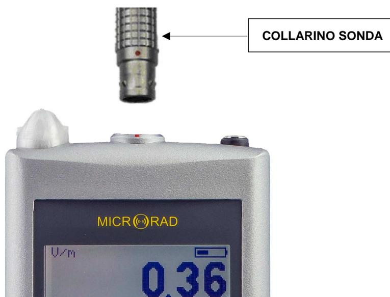
Fig. 5.1 – Collegamento delle sonde
